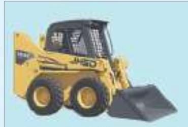
스키드로더 ម៉ាស៊ីនចូក(ដី) 스키드로더로 폐기물을 치웁니다. ធ្វើការសម្អាតយកកាកសំណល់ចេញ ដោយប្រើប្រាស់ម៉ាស៊ីនចូក។
